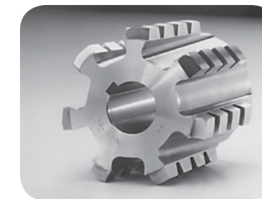
Se encuentran disponibles engranajes con ranuras de limpieza para aplicaciones que son propensas a generar acumulación de productos. Patentes de EE. UU. n.º 5,816,988 y 6,041,916
